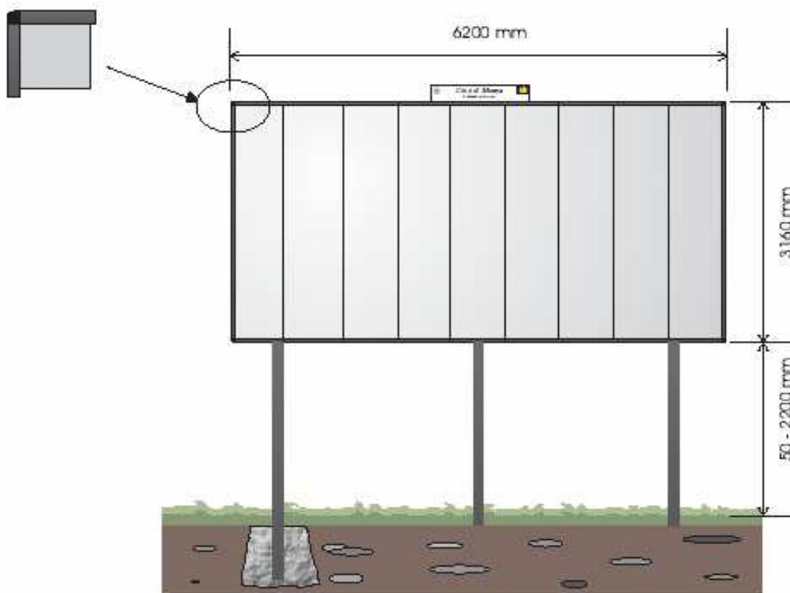
L'impianto denominato poster è formato da una cornice costituita da un profilo in alluminio in lega 6060, le cui misure sono: 100x40x2 mm. Questo profilo usato per formare la cornice, appositamente lavorato, sarà unito agli angoli tramite squadrette in acciaio zincato piegate a trapezio con angoli di 135°, fissate alle due estremità con bulloneria in acciaio ad alta resistenza.
