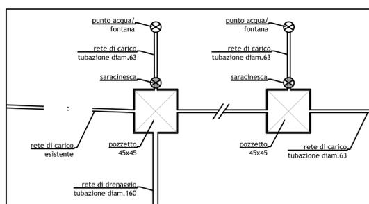
Dettaglio della Rete Idrica
