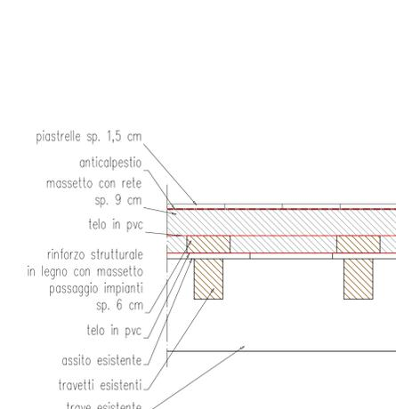
**PARTICOLARE COSTRUTTIVO SOLAIO PIANO PRIMO
